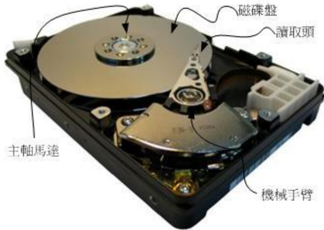
图 0.2.4、硬盘物理构造(图片取自维基百科)
